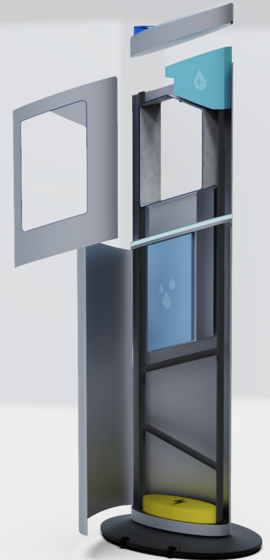
Explosionsdarstellung: Das Innengerüst bietet eine stabile Basis mit genügend Platz für Akku, Auffangbehälter und Desinfektionsmittel-Reservoir.
